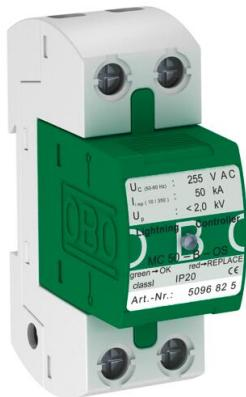
Parafoudre type 1 selon la norme DIN EN 61643-11 avec affichage de fonction pour installation à l'interface 0 sur 1 (LPZ) conformément au concept des zones de protection contre la foudre selon la norme CEI 61312-1ou VDE 0185-305 (CEI 62305)
