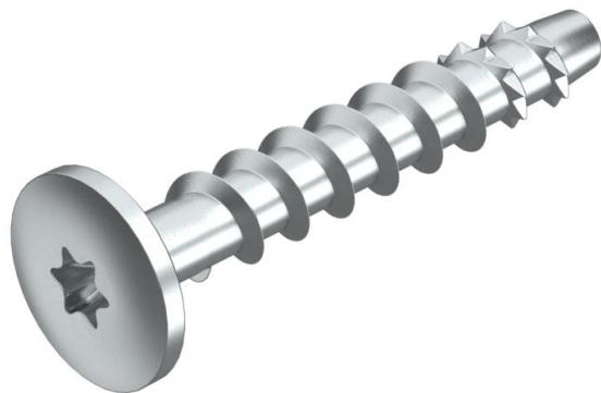
Vis d'ancrage pour le montage direct sans cheville dans de la maçonnerie ainsi que dans du béton fissuré et non fissuré. Avec une grande tête ronde pour la fixation de rails de montage et de profilés. Entraînement Torx T30.
