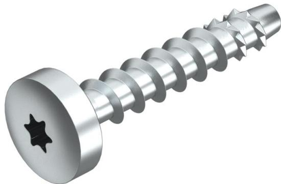
Vis d'ancrage pour le montage direct sans cheville dans de la maçonnerie ainsi que dans du béton fissuré et non fissuré. À tête ronde pour des fixations universelles. Entraînement Torx T30.
