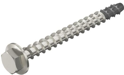
Boulon d'ancrage en acier inox pour montage direct sans cheville dans du béton fissuré ou non fissuré ainsi que la maçonnerie. Avec entraînement hexagonal et rondelle pressée pour la fixation de charges importantes. Convient pour la fixation de montants suspendus et de montants muraux dans les locaux humides et à l'extérieur.
