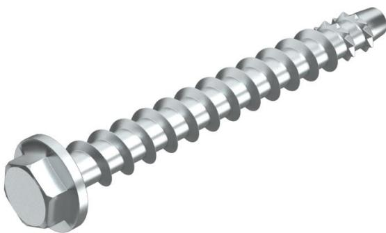
Vis d'ancrage pour le montage direct sans cheville dans de la maçonnerie ainsi que dans du béton fissuré et non fissuré. Avec entraînement hexagonal et rondelle pressée pour la fixation de charges importantes. Convient pour la fixation de pendants et consoles murales.
