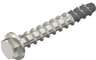
Boulon d'ancrage en acier inox pour montage direct sans cheville dans du béton fissuré ou non fissuré ainsi que la maçonnerie. Avec entraînement hexagonal et rondelle pressée pour la fixation de charges importantes. Convient pour la fixation de montants suspendus et de montants muraux dans les locaux humides et à l'extérieur.
