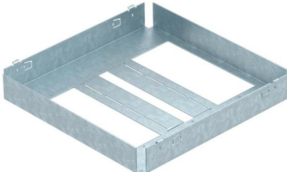
Support de montage pour le montage de trois plaques de recouvrement APMT5, utilisées pour installer des appareils sous des cassettes avec cadre RKS dans la boîte de sol UZD250-3.
