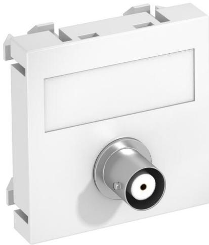
Support multimédia avec une prise de raccordement BNC, sortie de câbles droite, avec champ d'inscription, raccord BNC en version femelle-femelle. Plaque-support avec fixation à encliquer, adaptée au montage horizontal et vertical dans l'environnement du système.
