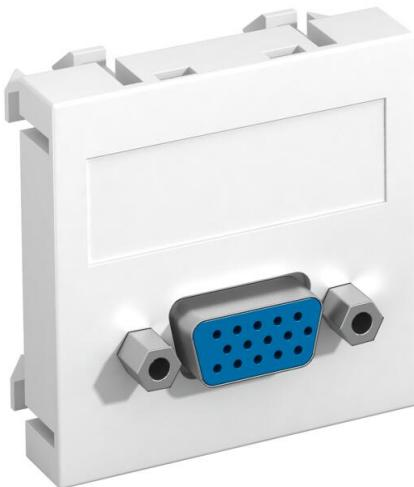
Support multimédia avec une prise de raccordement VGA, sortie de câbles droite, avec champ d'inscription, prise VGA (HD15) avec raccord à vis. Plaque-support avec fixation à encliquer, adaptée au montage horizontal et vertical dans l'environnement du système.
