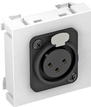
Support multimédia avec une prise de raccordement XLR, sortie de câbles droite, sans champ d'inscription, prise XLR 3 pôles avec raccord à vis. Plaque-support avec fixation à encliquer, adaptée au montage horizontal et vertical dans l'environnement du système.
