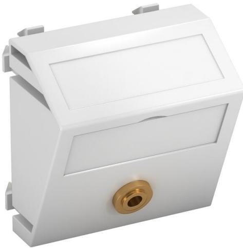
Support multimédia avec une prise de raccordement miniport, sortie de câbles oblique, avec champ d'inscription, prise miniport (TRS 3,5 mm) avec raccord soudé. Plaque-support avec fixation à encliquer, adaptée au montage horizontal et vertical dans l'environnement du système.
