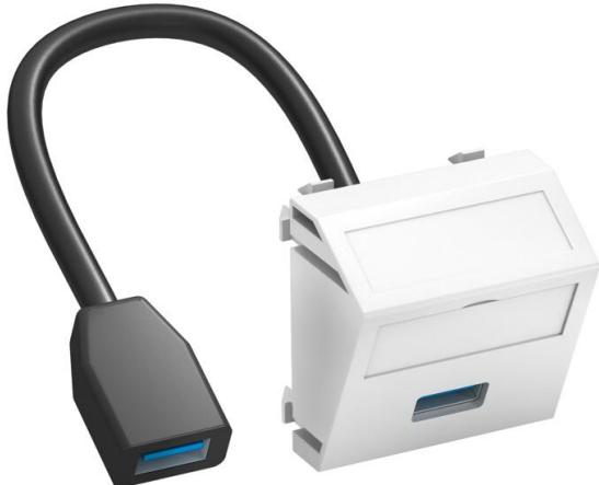
Support multimédia avec une prise de raccordement USB 3.0, sortie de câbles oblique, avec champ d'inscription, raccord USB 3.0 type A court en version femelle-femelle. Plaque-support avec fixation à encliquer, adaptée au montage horizontal et vertical dans l'environnement du système.
