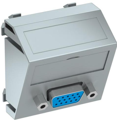
Support multimédia avec une prise de raccordement VGA, sortie de câbles oblique, avec champ d'inscription, prise VGA (HD15) avec raccord à vis. Plaque-support avec fixation à encliquer, adaptée au montage horizontal et vertical dans l'environnement du système.
