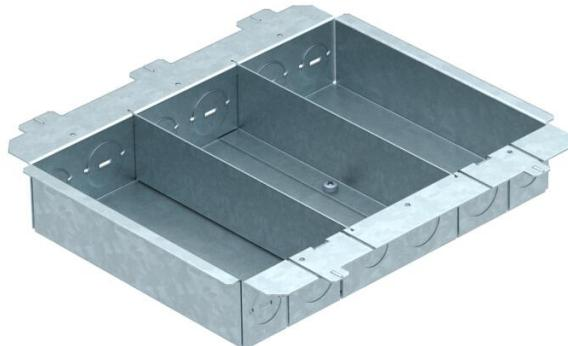
Support de montage fermé pour le logement de 3 plaques de recouvrement APMT5. Le support de montage se fixe sous le support d'encastrement GES9DB. Chacun avec 6 entrées défonçables pour ouvertures M20 et M25 pour la fixation des tuyaux flexibles.
