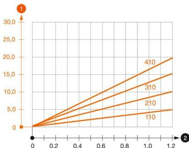
Diagramme de charge de la console MWAM 12
