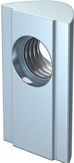
Clavettes rainurées de filetage M8 pour montage d'éléments et d'accessoires sur le profil des colonnes industrielles ISS. Un élément de pression au niveau du socle permet d'introduire la clavette rainurée dans la rainure et de l'y maintenir. Protection antitorsion automatique grâce au profilage du couvercle.
