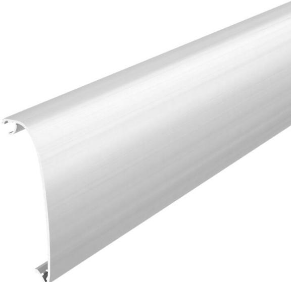
Couvercle de goulotte pour la réalisation d'une goulotte de montage d'appareillages design de la série GAD. Modèle design "Soft" pour une fermeture complète de l'ouverture système et des prises et interrupteurs. Les adaptateurs de couvercle GAD OTA sont impérativement nécessaires et doivent être planifiés à une distance max. de 50 cm sur la ligne de goulettes. Une entretoise GAD OTD doit être utilisée entre les couvercles de goulettes.
