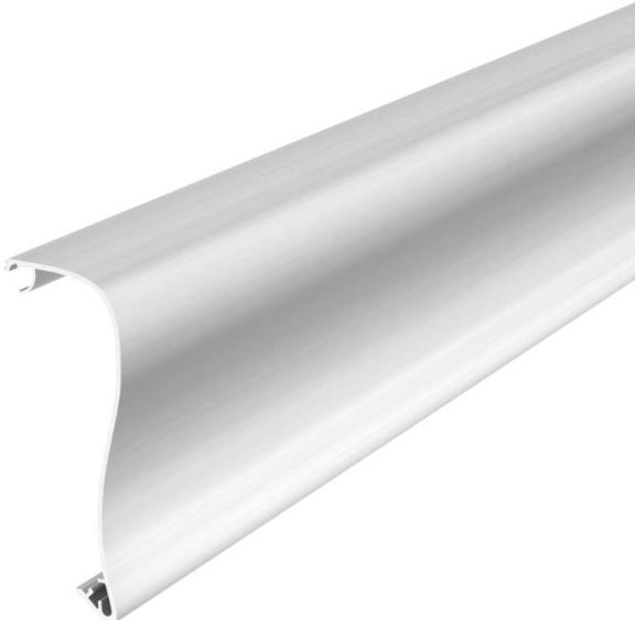
Couvercle de goulotte pour la réalisation d'une goulotte de montage d'appareillages design de la série GAD. Modèle design "Swing" pour une fermeture complète de l'ouverture système et des prises et interrupteurs. Les adaptateurs de couvercle GAD OTA sont impérativement nécessaires et doivent être planifiés à une distance max. de 50 cm sur la ligne de goulettes. Une entretoise GAD OTD doit être utilisée entre les couvercles de goulettes.
