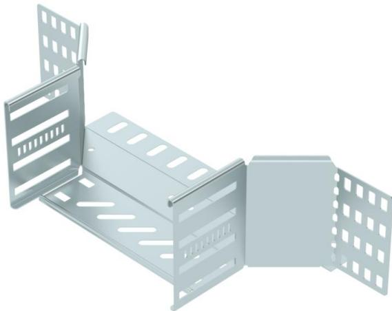
Dérivation à monter pour créer une dérivation horizontale ou une croix, pièce de forme pour chemins de câbles encliquetables et vissables d'une hauteur d'aile de 110 mm. Montage sans vis avec bornes doubles ou raccord vissé avec vis à tête bombée FRS et écrous à rondelle sertie M6. Utilisable en intérieur. Le matériel de fixation doit être commandé séparément.
