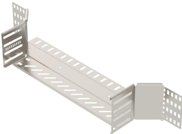
Dérivation à monter pour créer une dérivation horizontale ou une croix, pièce de forme pour chemins de câbles encliquetables et vissables d'une hauteur d'aile de 110 mm. Montage sans vis avec bornes doubles ou raccord vissé avec vis à tête bombée FRS et écrous à rondelle sertie M6. Utilisable en intérieur et en extérieur. Le matériel de fixation doit être commandé séparément.
