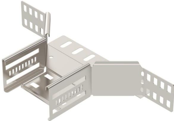
Dérivation à monter pour créer une dérivation horizontale ou une croix, pièce de forme pour chemins de câbles encliquetables et vissables d'une hauteur d'aile de 60 mm. Montage sans vis avec bornes doubles ou raccord vissé avec vis à tête bombée FRS et écrous à rondelle sertie M6. Utilisable en intérieur et en extérieur. Le matériel de fixation doit être commandé séparément.
