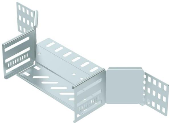
Dérivation à monter pour créer une dérivation horizontale ou une croix, pièce de forme pour chemins de câbles encliquetables et vissables d'une hauteur d'aile de 85 mm. Montage sans vis avec bornes doubles ou raccord vissé avec vis à tête bombée FRS et écrous à rondelle sertie M6. Utilisable en intérieur. Le matériel de fixation doit être commandé séparément.
