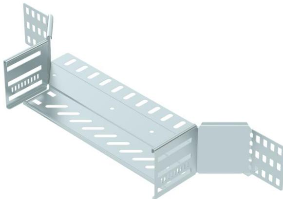
Dérivation à monter pour créer une dérivation horizontale ou une croix, pièce de forme pour chemins de câbles encliquetables et vissables d'une hauteur d'aile de 85 mm. Montage sans vis avec bornes doubles ou raccord vissé avec vis à tête bombée FRS et écrous à rondelle sertie M6. Utilisable en intérieur. Le matériel de fixation doit être commandé séparément.
