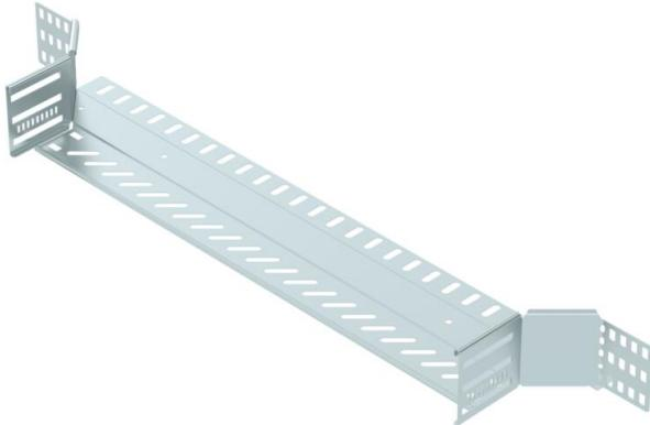
Dérivation à monter pour créer une dérivation horizontale ou une croix, pièce de forme pour chemins de câbles encliquetables et vissables d'une hauteur d'aile de 85 mm. Montage sans vis avec bornes doubles ou raccord vissé avec vis à tête bombée FRS et écrous à rondelle sertie M6. Utilisable en intérieur. Le matériel de fixation doit être commandé séparément.
