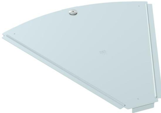
Couvercle pour pièce de forme coude à 45° pour chemins de câbles encliquetables et visssables en intérieur et en extérieur, pour protéger le câble contre les dommages et la saleté. Fixation avec verrou tournant prémonté et par appui sur le couvercle pour chemin de câbles. Convient à toutes les hauteurs d'ailes. Le couvercle peut être utilisé avec des pièces de forme de toutes hauteurs d'ailes.
