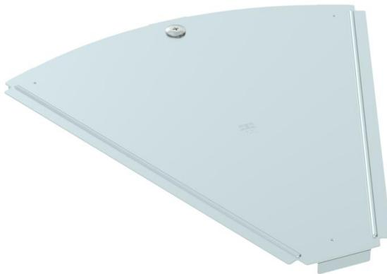
Couvercle pour pièce de forme coude à 45° pour chemins de câbles encliquetables et visssables en intérieur, pour protéger le câble contre les dommages et la saleté. Fixation avec verrou tournant prémonté et par appui sur le couvercle pour chemin de câbles. Convient à toutes les hauteurs d'ailes.
