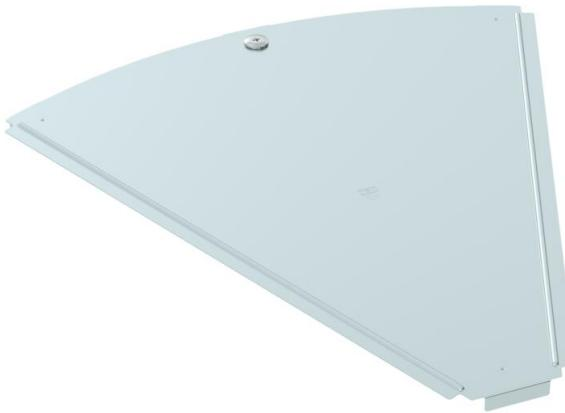
Couvercle pour pièce de forme coude à 45° pour chemins de câbles encliquetables et visssables en intérieur et en extérieur, pour protéger le câble contre les dommages et la saleté. Fixation avec verrou tournant prémonté et par appui sur le couvercle pour chemin de câbles. Convient à toutes les hauteurs d'ailes. Le couvercle peut être utilisé avec des pièces de forme de toutes hauteurs d'ailes.
