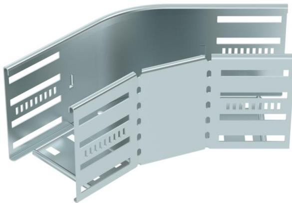
Coude à 45° pour créer une dérivation horizontale, pièce de forme pour chemins de câbles encliquetables et vissables d'une hauteur d'aile de 110 mm. Montage sans vis avec bornes doubles ou raccord vissé avec vis à tête bombée FRS et écrous à rondelle sertie M6. Utilisable en intérieur. Le matériel de fixation doit être commandé séparément.
