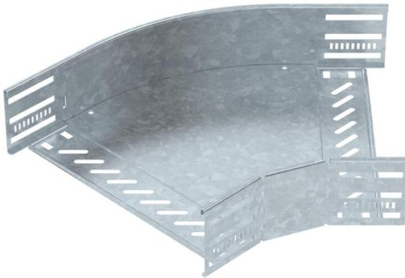
Coude à 45° pour créer une dérivation horizontale, pièce de forme pour chemins de câbles encliquetables et vissables d'une hauteur d'aile de 85 mm. Montage sans vis avec bornes doubles ou raccord vissé avec vis à tête bombée FRS et écrous à rondelle sertie M6. Utilisable en intérieur et en extérieur. Le matériel de fixation doit être commandé séparément.
