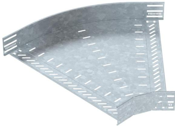
Coude à 45° pour créer une dérivation horizontale, pièce de forme pour chemins de câbles encliquetables et vissables d'une hauteur d'aile de 85 mm. Montage sans vis avec bornes doubles ou raccord vissé avec vis à tête bombée FRS et écrous à rondelle sertie M6. Utilisable en intérieur et en extérieur. Le matériel de fixation doit être commandé séparément.
