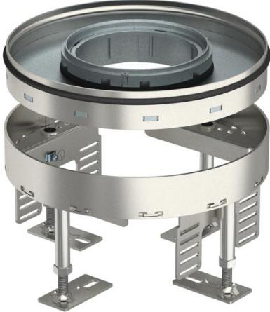
Cassette ronde pour charges lourdes pour tube de taille nominale R4 pour le montage d'appareillages dans des systèmes de goulottes, des faux-planchers et des planchers creux, dans des planchers nettoyés à l'eau ou à sec en intérieur. Classe de charge 2 jusqu'à 20 kN.
