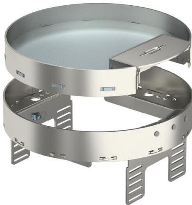
Cassette réglable en hauteur et découpée par rapport au plancher de taille nominale R4, avec sortie de cordon, pour le montage d'appareillages dans des planchers nettoyés à sec en intérieur, pour le montage dans des boîtes de tirage UZD250-3 ou UZD350-3 en association avec un couvercle de montage DUG./R4 ou dans des boîtes de tirage UGD250-3R4 ou UGD350-3R4. Le montage s'effectue à l'aide d'équerres de niveling (à commander séparément) dans le profilé de cadre en aluminium des boîtes de tirage.
