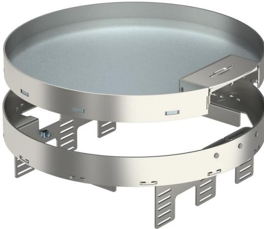
Cassette réglable en hauteur et découpée par rapport au plancher de taille nominale R9, avec sortie de cordon, pour le montage d'appareillages dans des planchers nettoyés à sec en intérieur, pour le montage dans des boîtes de tirage UZD350-3 en association avec un couvercle de montage DUG350-3R9 ou dans des boîtes de tirage UGD350-3R9. Le montage s'effectue à l'aide d'équerres de nivellement (à commander séparément) dans le profilé de cadre en aluminium des boîtes de tirage.
