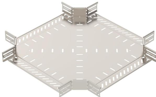
Croix pour créer une dérivation horizontale, pièce de forme pour chemins de câbles encliquetables et visssables d'une hauteur d'aile de 60 mm. Montage sans vis avec bornes doubles ou raccord vissé avec vis à tête bombée FRS et écrou à rondelle sertie M6. Utilisable en intérieur et en extérieur. Le matériel de fixation doit être commandé séparément.
