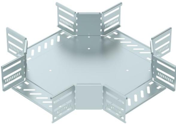
Croix pour créer une dérivation horizontale, pièce de forme pour chemins de câbles encliquetables et visssables d'une hauteur d'aile de 85 mm. Montage sans vis avec bornes doubles ou raccord vissé avec vis à tête bombée FRS et écrous à rondelle sertie M6. Utilisable en intérieur. Le matériel de fixation doit être commandé séparément.
