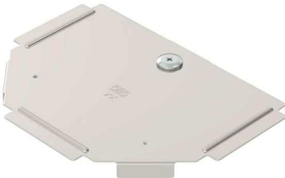
Couvercle pour pièce de forme pièce en T pour chemins de câbles encliquetables et visssables en intérieur et en extérieur, pour protéger le câble contre les dommages et la saleté. Fixation avec verrou tournant prémonté et fixation par appui sur le couvercle pour chemin de câbles. Convient à toutes les hauteurs d'ailes.
