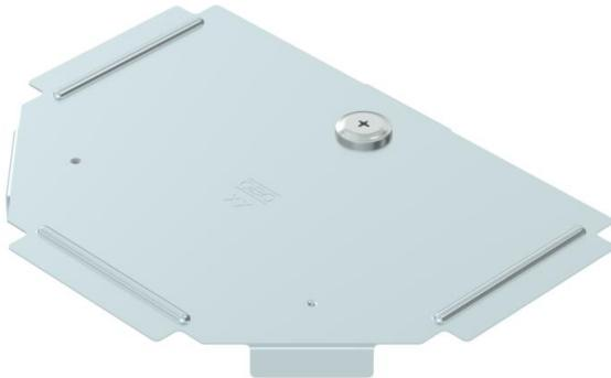
Couvercle pour pièce de forme pièce en T pour chemins de câbles encliquetables et visssables en intérieur et en extérieur, pour protéger le câble contre les dommages et la saleté. Fixation avec verrou tournant prémonté et fixation par appui sur le couvercle pour chemin de câbles. Convient à toutes les hauteurs d'ailes.
