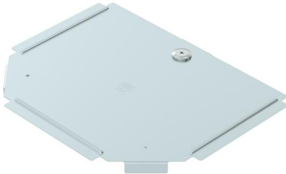
Couvercle pour pièce de forme pièce en T pour chemins de câbles encliquetables et visssables en intérieur, pour protéger le câble contre les dommages et la saleté. Fixation avec verrou tournant prémonté et fixation par appui sur le couvercle pour chemin de câbles. Convient à toutes les hauteurs d'ailes.
