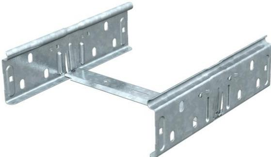
Kit d'éclissage rapide permettant l'assemblage linéaire sans vis des chemins de câbles et des pièces de forme d'une hauteur d'aile de 60 mm.
