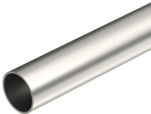
Tube d'installation électrique sans extrémités filetées selon la norme EN 61386-1, pour la protection mécanique de câbles et de conducteurs. Avec paroi intérieure sans ébarbure. Classe de protection anticorrosion 4 (élevée). Classification selon DIN EN 61386-1: 555711404010
