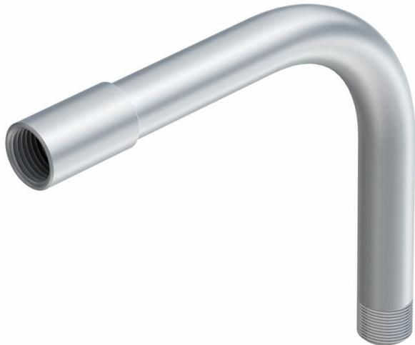
Coude à 90° pour les tubes électriques selon EN 61386-1, équipés d'extrémités filetées selon DIN 60423. Avec paroi intérieure sans ébarbure.
