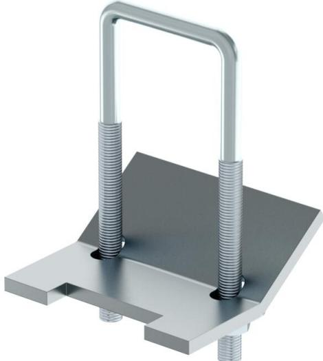
Élément de raccordement pour une fixation sur les deux côtés de rails profilés sur poutres métalliques. Le montage est possible quelle que soit la disposition de l'ouverture du rail. La longueur du rail doit être au moins égale à la largeur de la poutre métallique + 2 x 50 mm.
