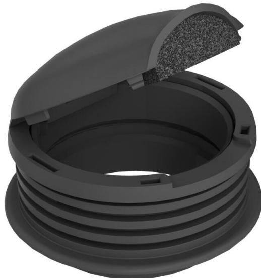
Couvercle de protection à fixer sur les boîtes de tirage sous chape UDL2-80 et les sorties sous chape, pour la protection de la sortie de câble dans des planchers à entretien humide à l'intérieur, avec bague en polyamide renforcé par nervures et joint d'étanchéité en caoutchouc.
