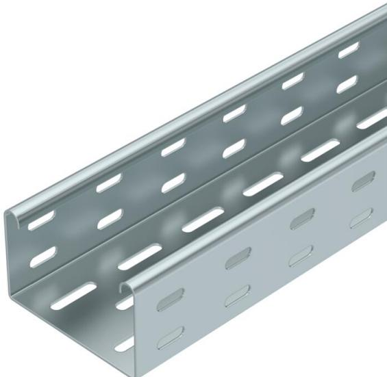
SKS 60 = Système de chemins de câbles lourd d'une hauteur latérale de 60 mm. Le chemin de câbles type SKS peut également être utilisé pour le maintien en fonction. Pour d'autres informations, se reporter aux systèmes de protection contre les incendies BSS ; Kit d'éclissage droit type RV 60 inclus dans la livraison. Atténuation magnétique du blindage sans couvercle 20 dB, avec couvercle 50 dB.
