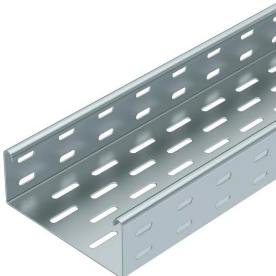
SKS 60 = Système de chemins de câbles lourd d'une hauteur latérale de 60 mm. Le chemin de câbles type SKS peut également être utilisé pour le maintien en fonction. Pour d'autres informations, se reporter aux systèmes de protection contre les incendies BSS ; Kit d'éclissage droit type RV 60 inclus dans la livraison. Atténuation magnétique du blindage sans couvercle 20 dB, avec couvercle 50 dB.
