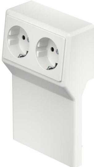
Support d'appareillages avec 2 prises de courant prémontées à contact de protection pour la goulotte sous plinthe dans une largeur de goulotte de 110 mm. Est vissé au mur, au-dessus du système de goulotte.
