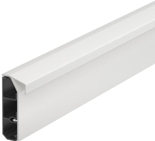
Goulotte sous plinthe SL-T pour la distribution encastrée des câbles à l'intérieur. La couleur de la partie inférieure peut avoir de nuances dû à la fabrication. Avec couvercle emboitable et socle poinçonné pour un montage direct au mur. Effectuez un changement de direction à l'aide d'une coupe et fermez les extrémités des conduits avec des embouts. Réservoir d'appareil pour le montage de systèmes électriques et de données. Avec retour tapis pour une finition propre.
