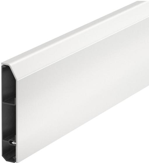
Goulotte à plinthe SL pour la distribution encastrée des câbles à l'intérieur. La couleur de la partie inférieure peut avoir de nuances dû à la fabrication. Avec couvercle emboitable et partie inférieure perforée au fond pour un montage direct au mur. Effectuer des changements de direction avec les pièces de forme et obturer les extrémités de goulotte à l'aide des embouts. Réservoir d'appareil pour le montage de systèmes électriques et de données. Testé selon DIN EN 50085-1 et DIN EN 50085-2-1.
