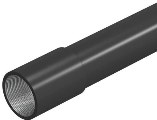
Tube d'installation électrique selon EN 61386-1 avec extrémités filetées selon la norme DIN EN 60423, pour la protection mécanique de câbles et conduits. Avec paroi intérieure sans ébarbure. Classe de protection anticorrosion 2 (moyenne). Un manchon de raccordement est déjà vissé sur chaque tube.
