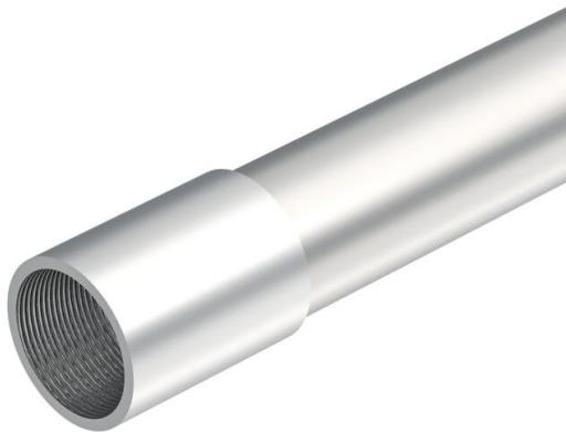
Tube d'installation électrique selon EN 61386-1 avec extrémités filetées selon la norme DIN EN 60423, pour la protection mécanique de câbles et conduits. Avec paroi intérieure sans ébarbure. Un manchon de raccordement est déjà vissé sur chaque tube.
